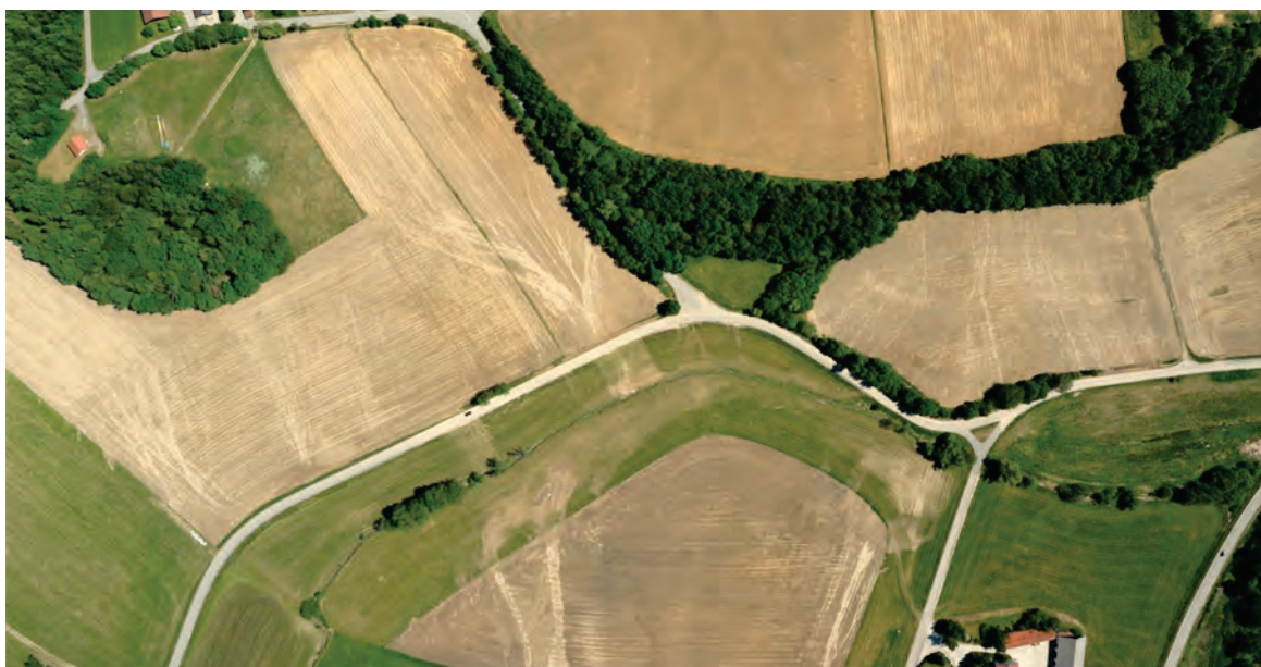
Abb.17: Typisches Erosionsluftbild: Abschwemmungen aus Maisfeldern, Anlandung im Grünland, Überspülen selbst von Straßen im Bereich von gebündeltem Abfluss und von dort Kurzschluss zum Gewässer
