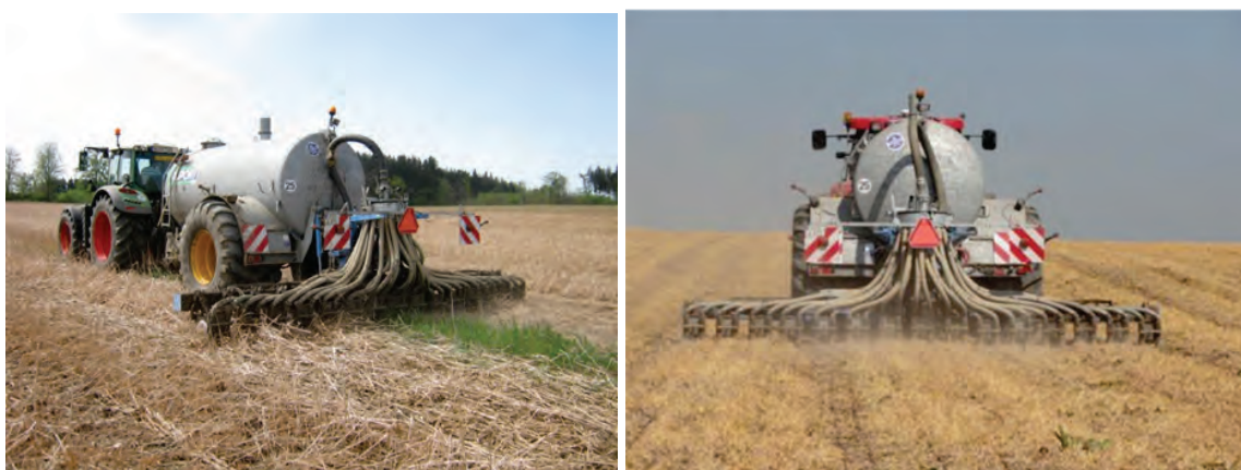
Abb. 8: Flächige Ausbringung von flüssigem Wirtschaftsdünger in abgefrorene Zwischenfruchtbestände mit einem Scheibenschlitzverteiler
