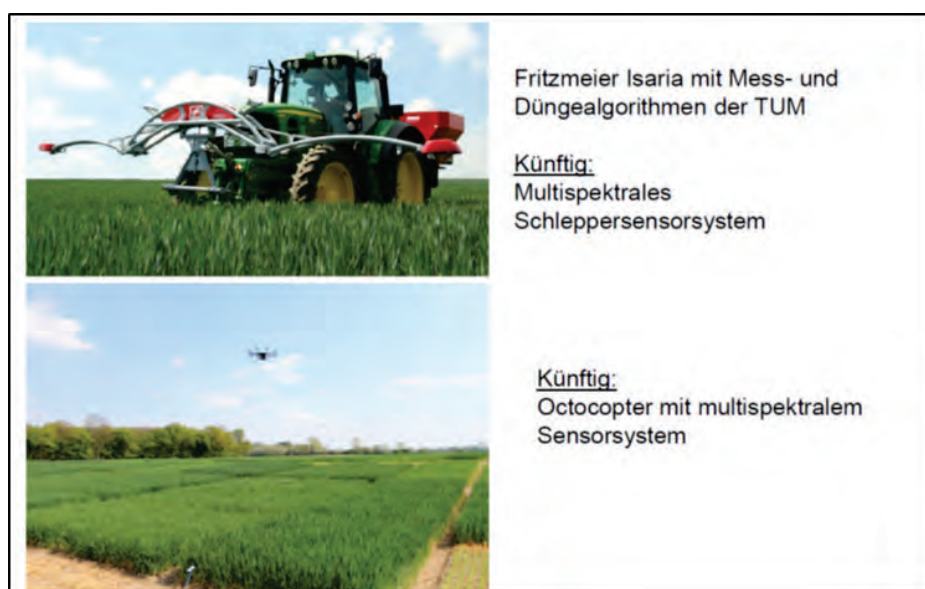
Abb. 10: Erträge messen und Düngermenge bestimmen mit Feldspektroskopie (Quelle: MAIDL (2014) [19])
