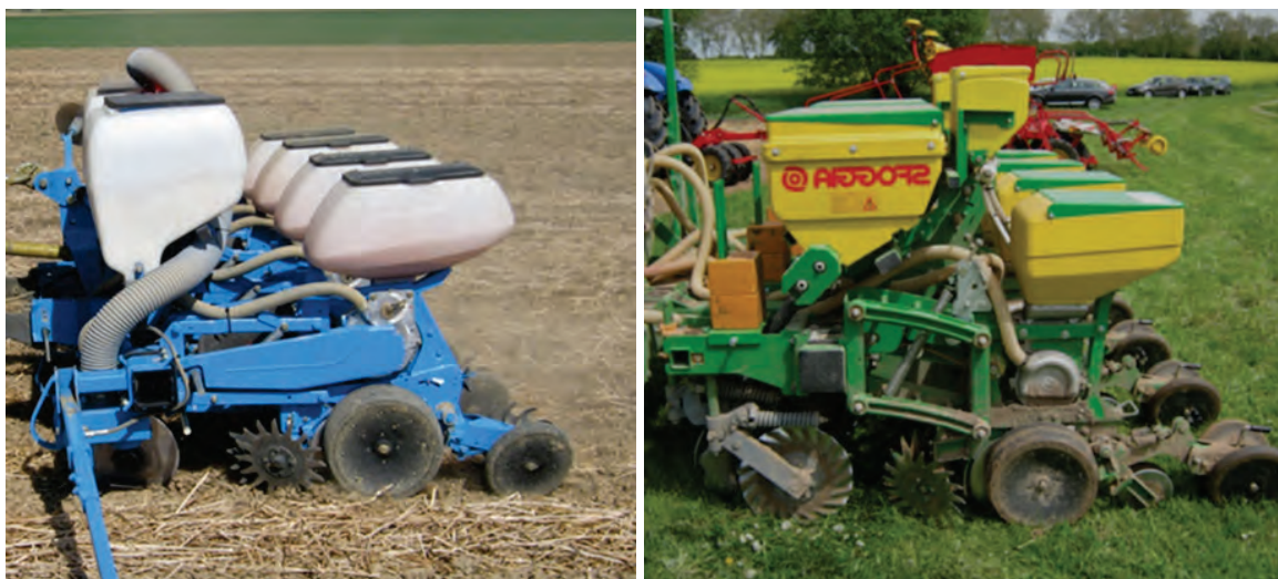
Abb. 11: Räumsterne bzw. Kombination aus (gewelltem) Scheibensech und Räumsternen für verbesserte Ablage und Einbettung bei Mulch- und Direktsaat.
