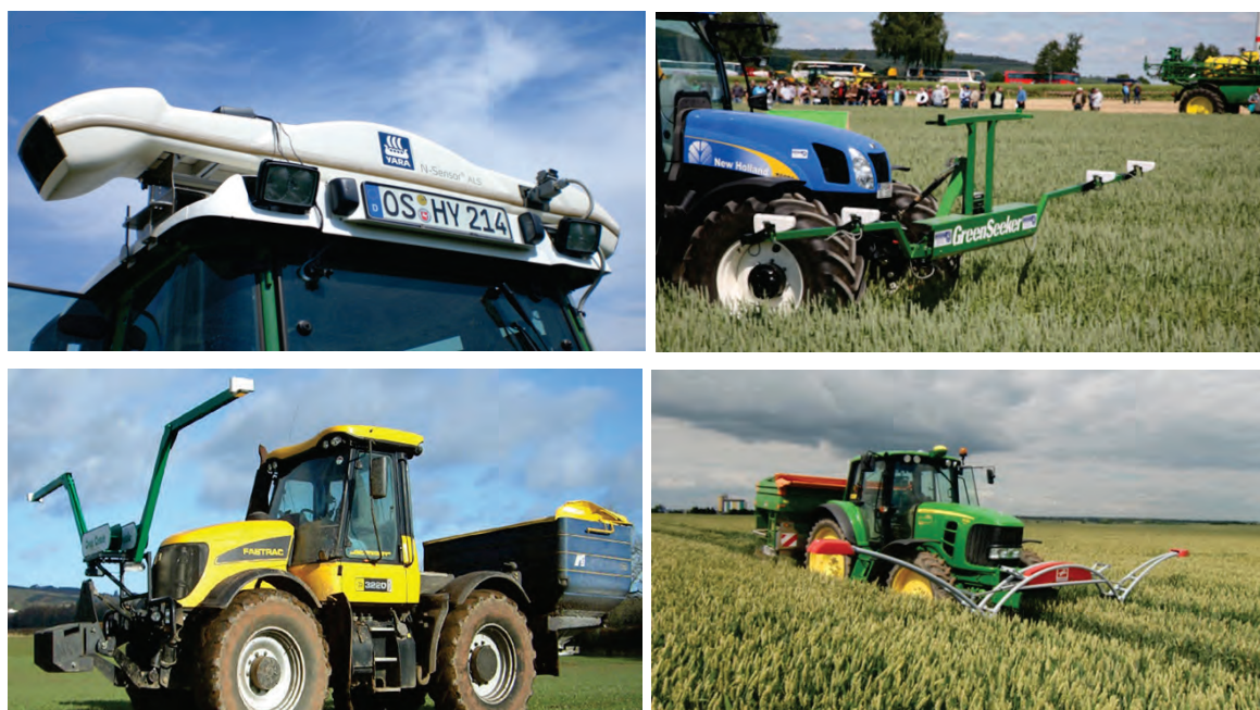
Abb. 11: Einige am Markt angebotene Sensorsysteme (links oben: Yara ALS, rechts oben: GreenSeeker, links unten: CropCircle, rechts unten: Isaria)
