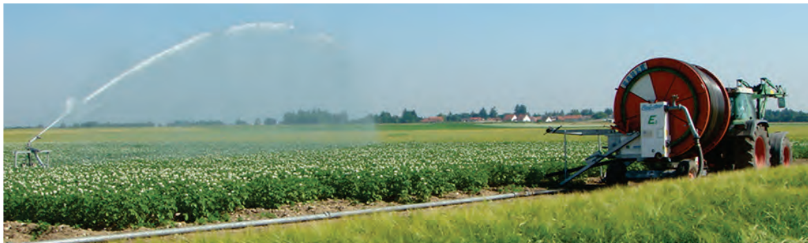
Abb. 6: Beregnungsmaschinen mit Regnereinzug: flexibel und mobil einsetzbar
